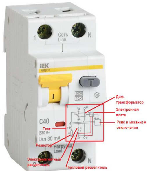
Автоматический выключатель дифференциального тока с электронным управлением (дифавтомат)
