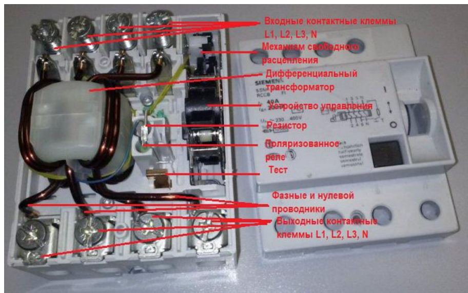
Устройство четырехполюсного электромеханического УЗО
