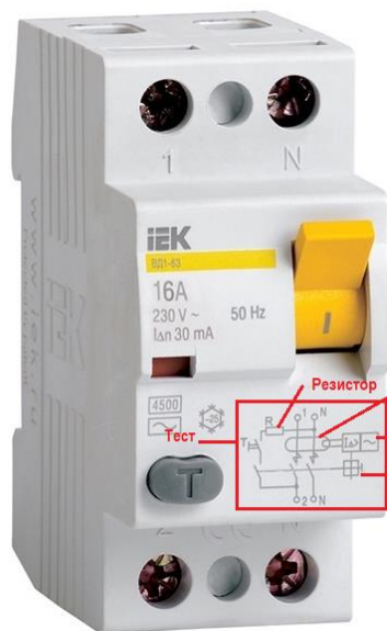
Выключатель дифференциальный с электромеханическим управлением (УЗО)
